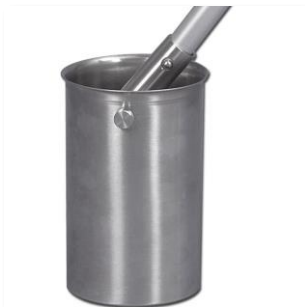
Figur 2. Pendelbägare för provtagning.
