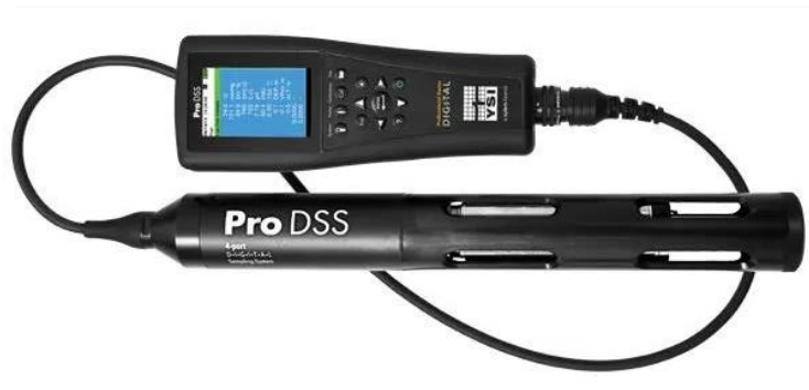
Figur 3. YSI ProDSS multiinstrument.
